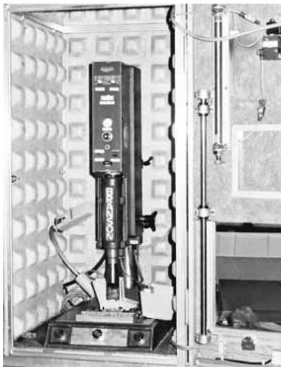
Bild 23: Gekapselte Ultraschallschweissmaschine (Türe der Kapselung geöffnet).
