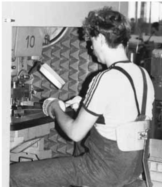
Bild 27: Exzenterstanzmaschine mit Teilkapselung. Die Bedienung der Maschine wird durch diese Massnahme nicht erschwert.
