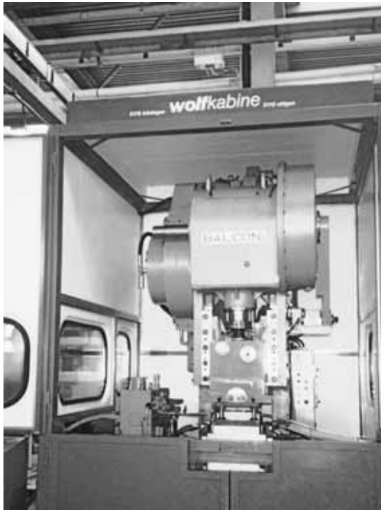
Bild 33: Frontseite der geöffneten Kapselung eines Stanzautomaten.
