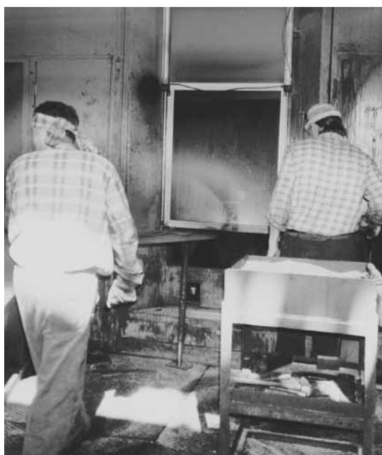
Bild 38: Pneumatisch betriebenes Acrylglasfenster vor dem Gesenk.
