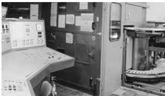
Bild 24: Teilansicht der Kapselung des Falzapparates an einer Rotationsmaschine: Links das Steuerpult, rechts das Förderband, auf dem die gefalteten Zeitschriften die Kapselung verlassen.
