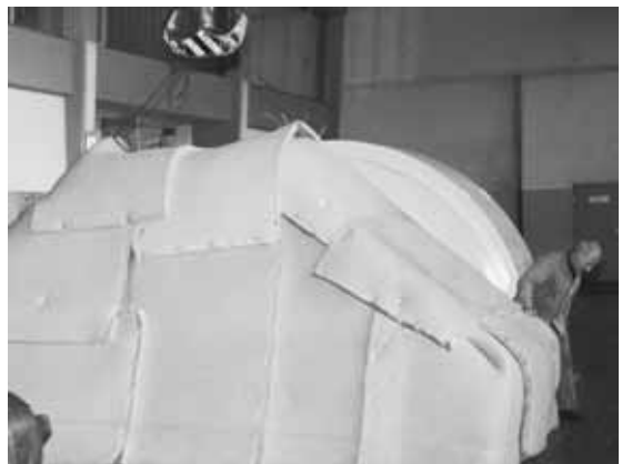
Bild 40: Schallschutzhaube für eine Peltonturbine, Versuchsaufbau.
