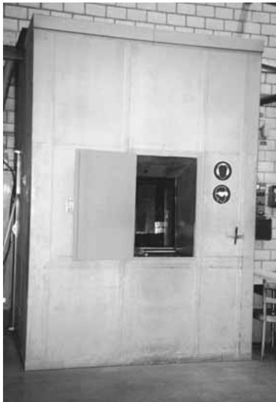
Bild 42: Kapselung der Einwurfseite bei einer Mühle für Kunststoffrohre.
