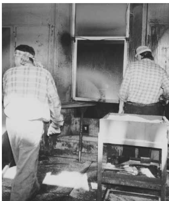
Bild 38: Pneumatisch betriebenes Acrylglasfenster vor dem Gesenk.
