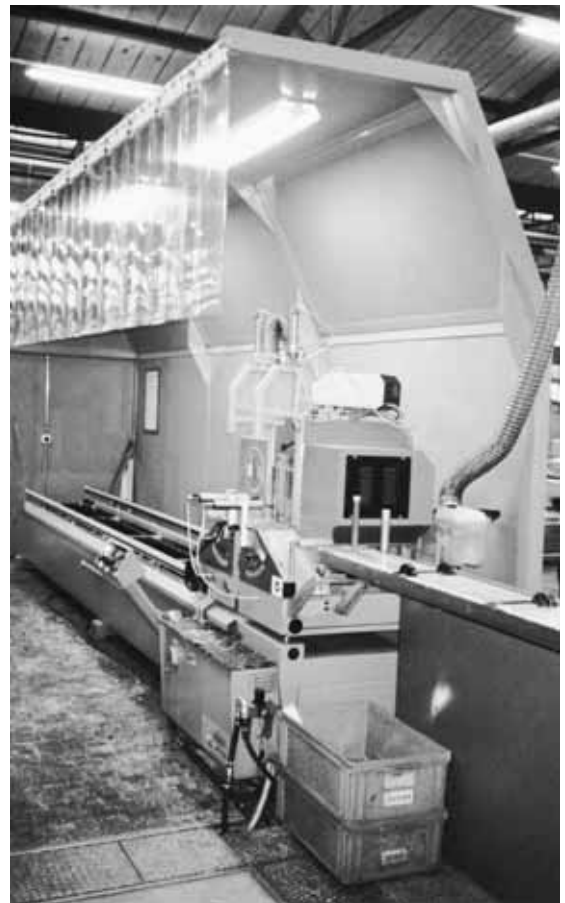
Bild 35: Teilkapselung einer Doppelgehrungskreissäge.
