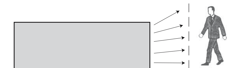
Bild 2 Der arbeitsplatzbezogene Emissionswert informiert über die Lärmabstrahlung am Arbeitsplatz.
